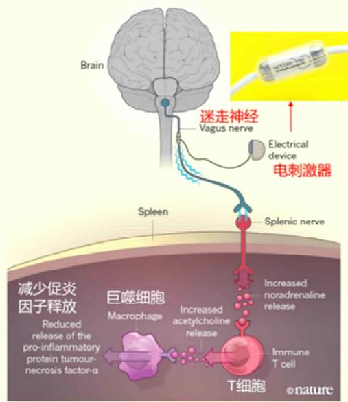
图 1 植入式迷走神经电刺激器抑制巨噬细胞释放炎症反应因子
